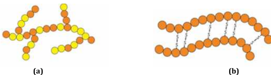
Figure 1.3 : Structures moléculaires : (a) d'un polymère thermoplastique, (b) d'un polymère thermodurcissable
