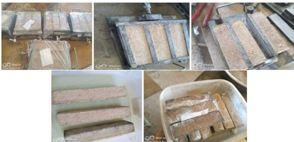
Figure II 18 : Démoulage des éprouvettes
