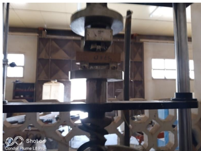
Figure II 20 : Essai de flexion à 3 points
