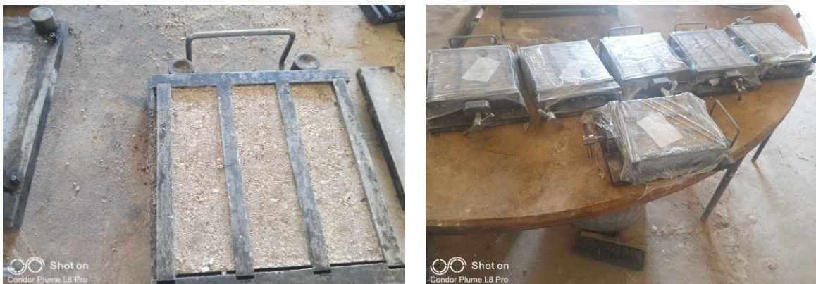
Figure II 16: Introduction du mortier dans les moules
