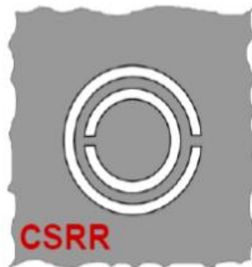
Figure II.14: Résonateur Complémentaire fondue d'anneaux CSRR.
