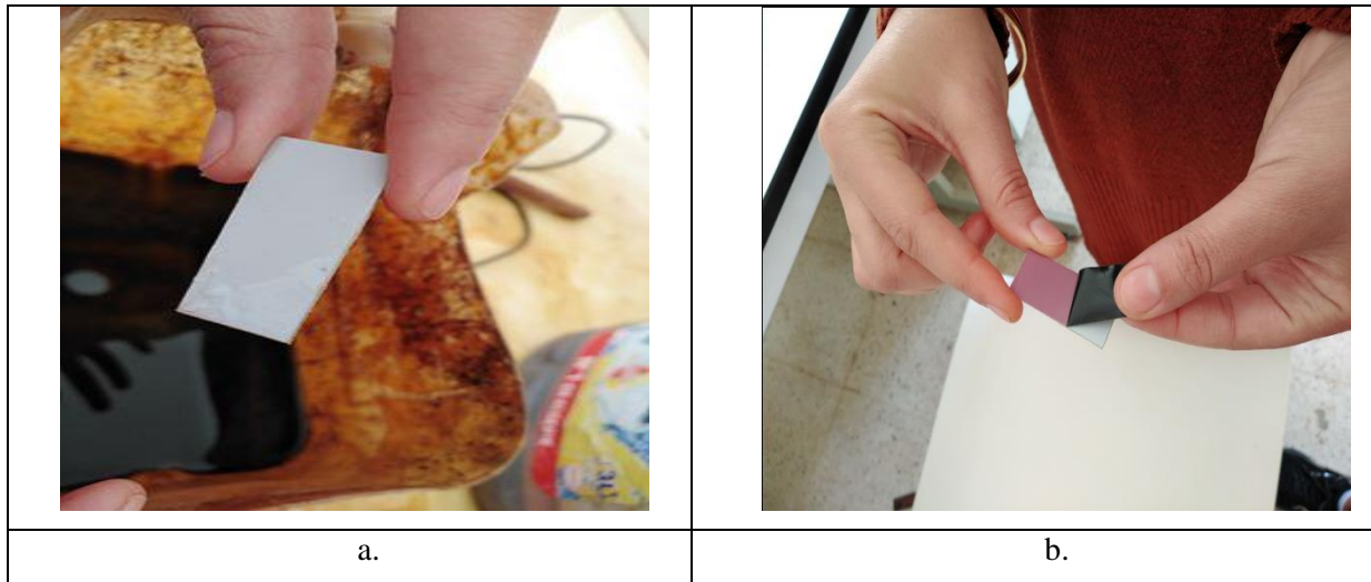
Figure III. 7 :(a) Perchlorure de fer. (b) Retirez l'isolateur de la carte PCB.
