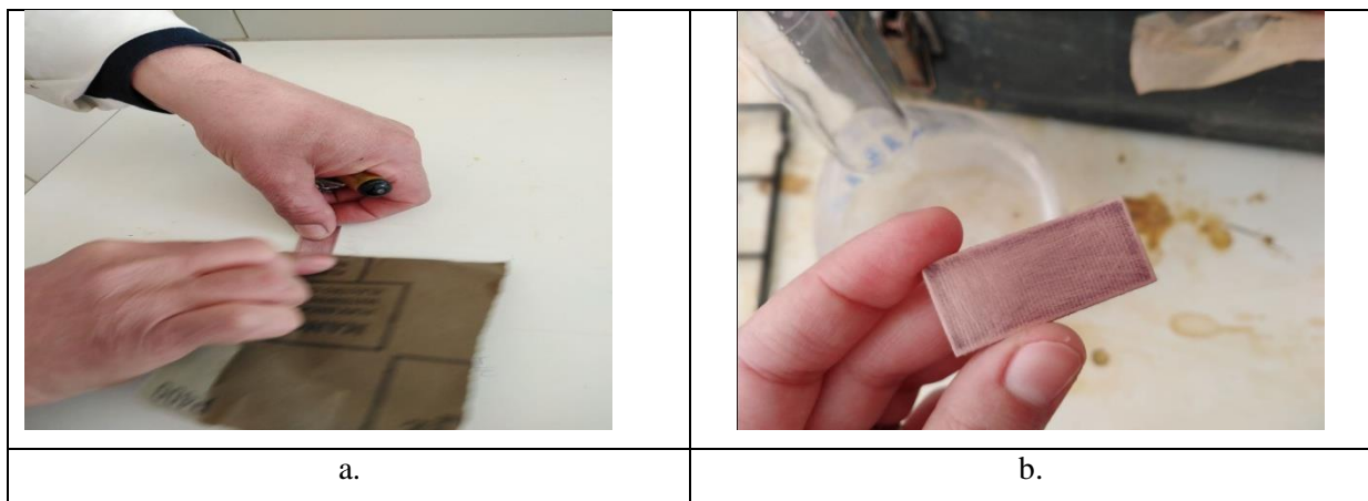
Figure III. 8 : Frottement de la carte PCB par un papier verre.
