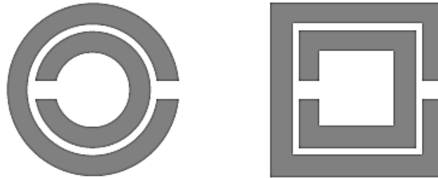
Figure II.5: Résonateur en anneau fendu (Split Ring Resonator (SRR)) [14].
