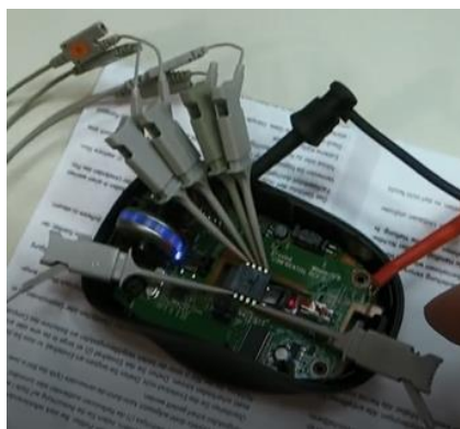
Figure III.2 Images montrant les trois différentes façons de relier une souris à une carte Arduino. Fils soudés sur les broches du capteur ( Image en haut à gauche ) – Fils soudés dans les trous du contrôleur de la souris après avoir dessouder ce dernier ( image à droite ) – Les broches du capteurs sont reliées à la carte Arduino avec des câbles à pinces ( image en bas à gauche )
