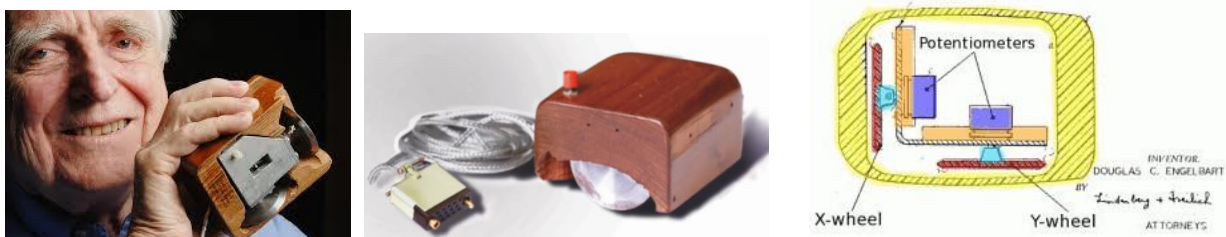
Figure I.2 Inventeur de la première souris d'ordinateur (à gauche) - Première souris d'ordinateur (au milieu) - Schéma de principe de la première souris d'ordinateur (à droite)
