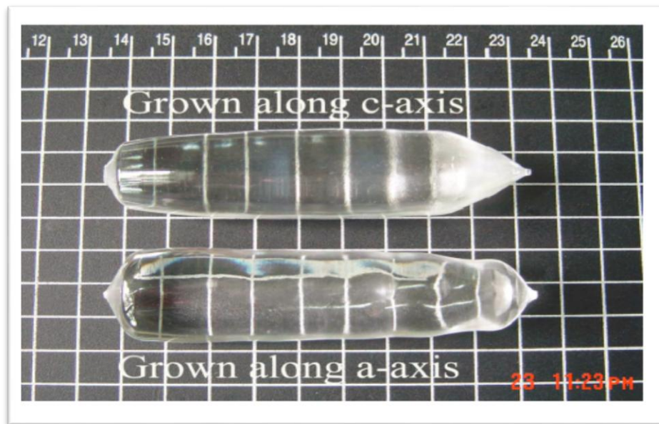
Figure I.2 : Cristal de \text{BaWO}_4 , élaboré par tirage Cozckralski [21].
