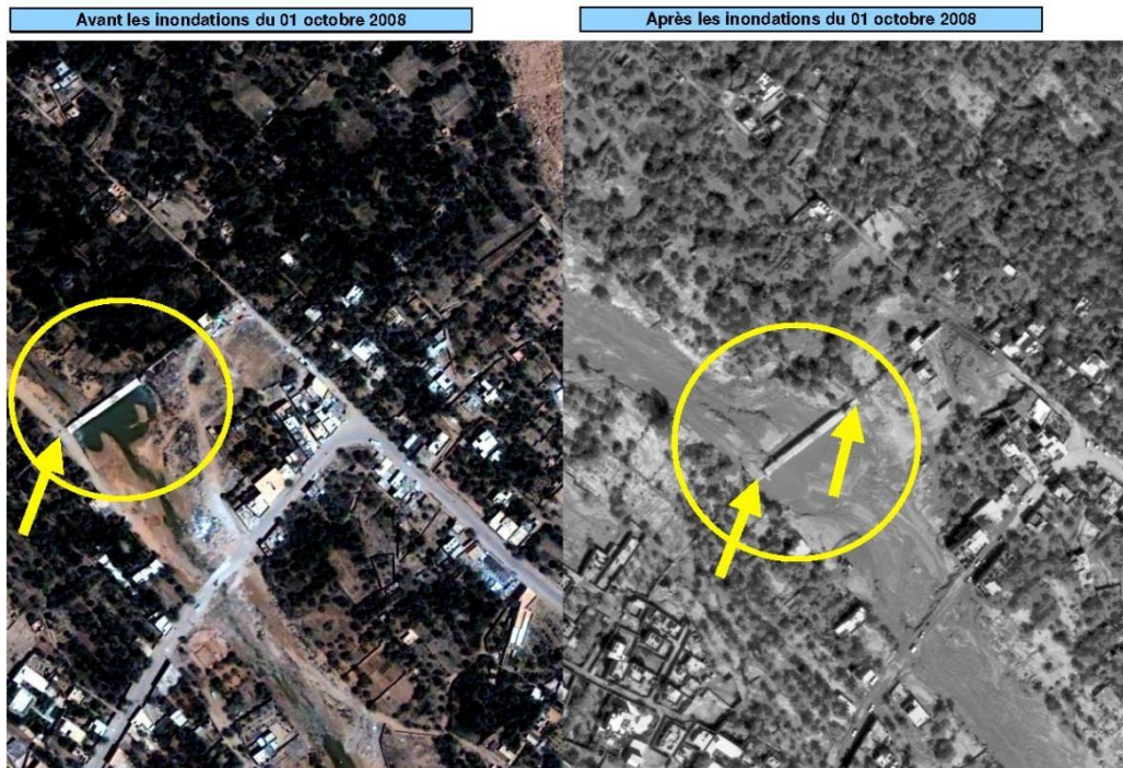
Figure Effondrement des routes qui sont reliées au pont (ASAL)
