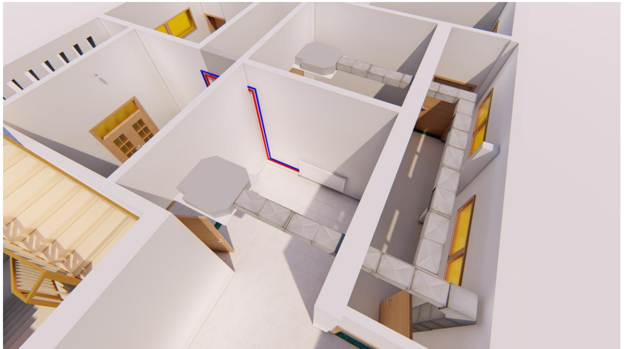
FigIII.B.14: les humidificateurs (système de climatisation en solaire)
