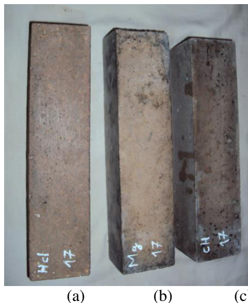
Figure IV.13 : Etat de surface des éprouvettes de BHP17 après 180 jours d'immersion-séchage dans les différents milieux (a) HCl, (b) MgSO_4 , (c) Eau saturée en chaux
