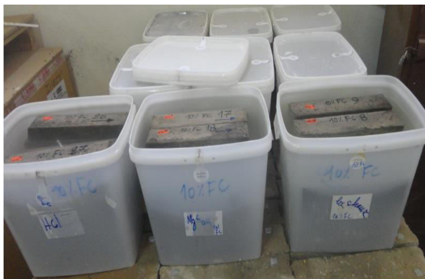
Figure II.9. Conservation des éprouvettes dans les milieux de conservation.
