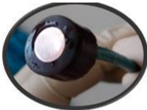
Figure II.4: Schéma de l'électrode de travail (cuivre).
