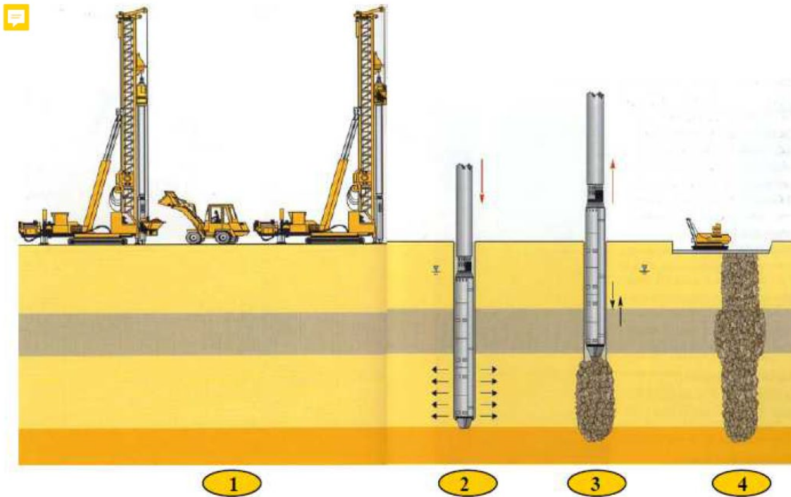
Figure III.17 : Mise en œuvre des colonnes ballastées par voie sèche (Documentt de Keller)
