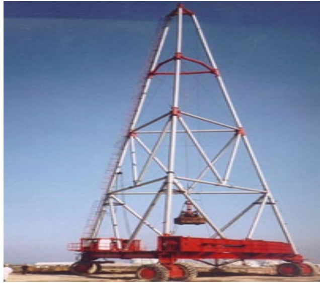
Figure III.12 : Engin utilisé pour la réalisation des plots ballastés ( Document de Ménard Soltraitement® )
