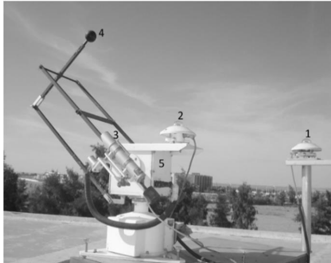
Figure I.5. Station radiométrique pour mesurer le rayonnement solaire global, direct et diffus à l'URAER/Ghardaia. (1) Pyranomètre pour mesurer l'irradiance solaire globale. (2) Pyranomètre pour mesurer le diffus. (3) Pyréliomètre pour mesurer l'irradiance solaire directe. (4) Pyranomètre ombré. (5) Le tracker solaire à 2 axes [9].
