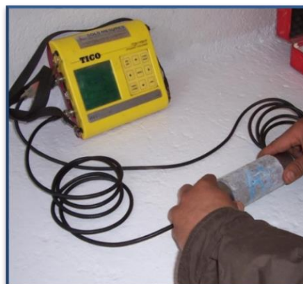
Figure II.3 : Essai d'ultrason (mesure de résistance de béton). [33] [34]
