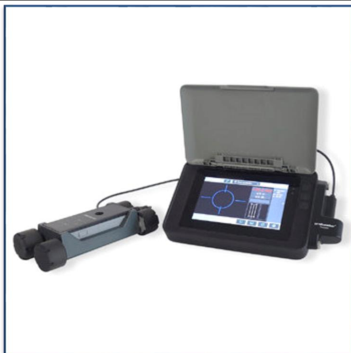
Figure II.4 : Corrosimètre type CANIN (détermine l'état de corrosion des armatures par mesure des potentiels de surface). [35]
