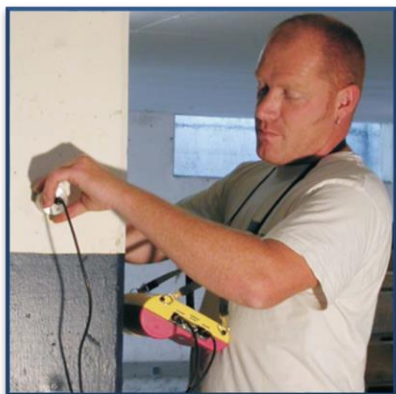
Figure II.3 : Essai d'ultrason (mesure de résistance de béton). [33] [34]
