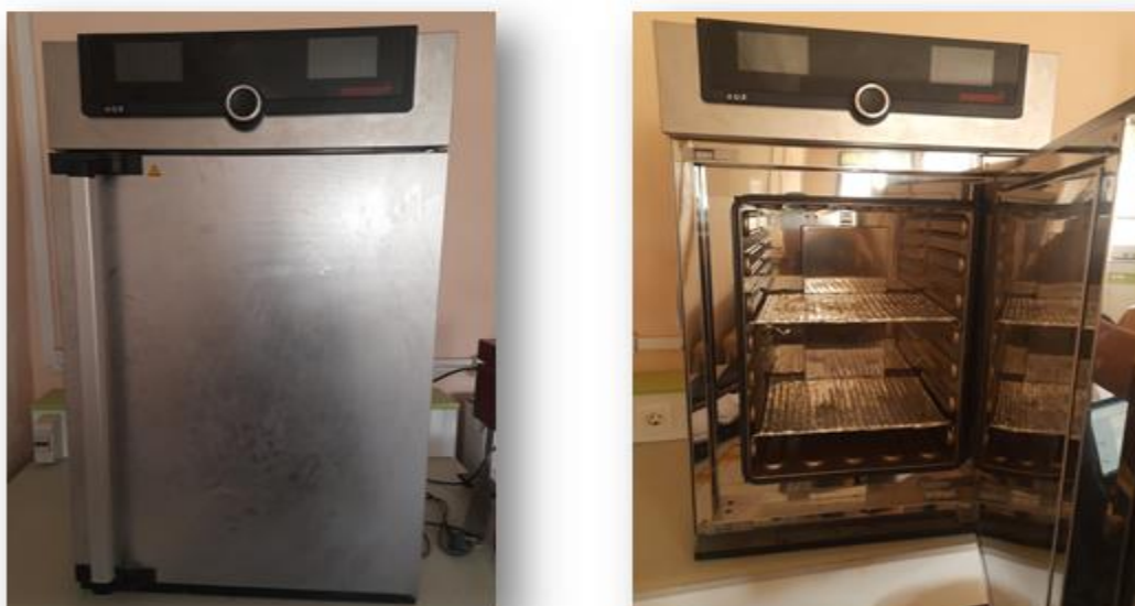
Figure II.5 : Photo de l'étuve de séchage utilisée au laboratoire.
