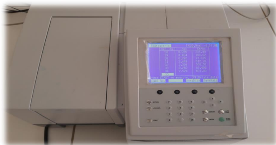
Figure II.1 : Photo du spectrophotomètre UV-Visible utilisé au laboratoire.
