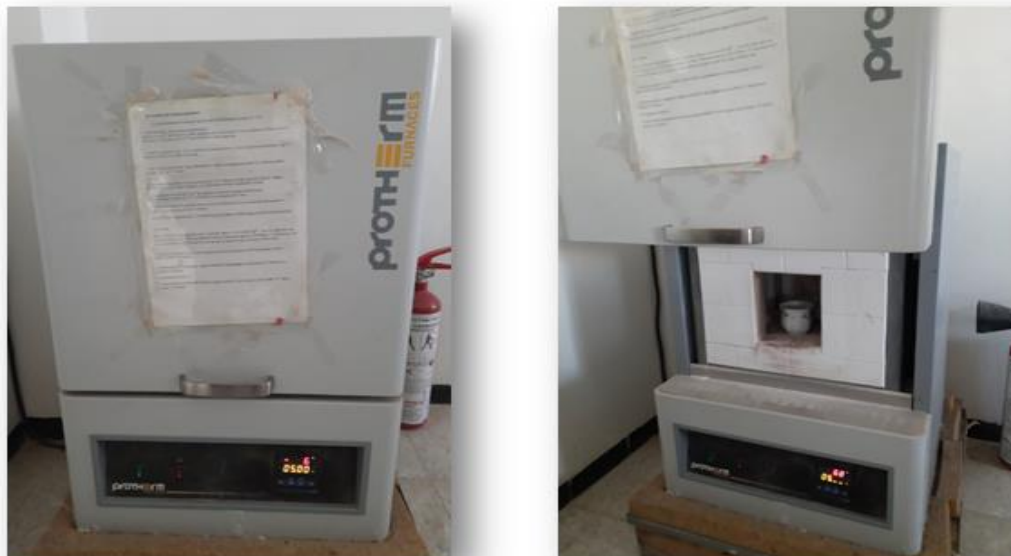
Figure II.4 : Photo du four à moufle pour calcination utilisée au laboratoire.
