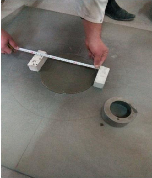
الشكل (3-11): تجربة الانتشار بالمخروط الصغير
