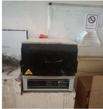
الشكل (2-18): يوضح جهاز الفرن
