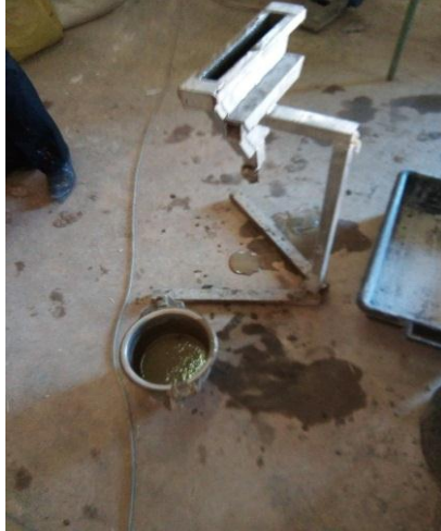
الشكل (2-12) يوضح ابعاد القمع الصغير على شكل حرف V
