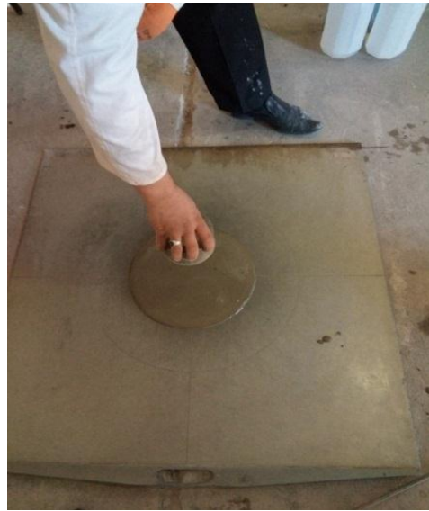
الشكل (3-11): تجربة الانتشار بالمخروط الصغير
