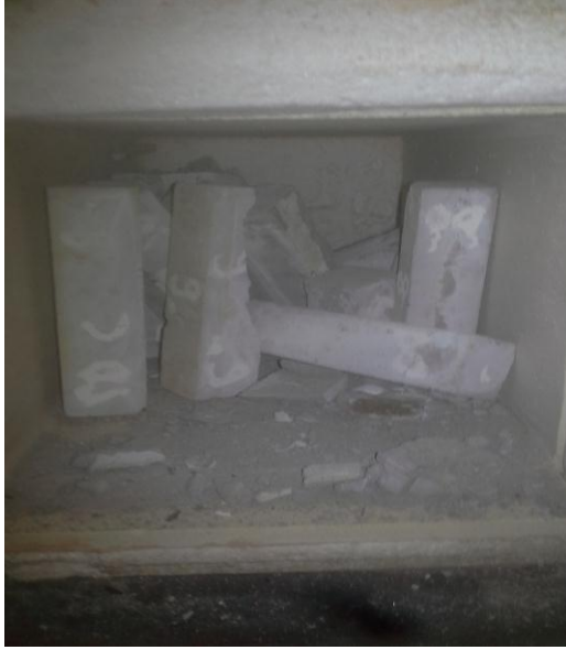
الشكل (3-32): تكسر العينات بفعل الحرارة العالية
