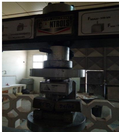
الشكل (2-16): يوضح تجربة الانحناء البسيط
