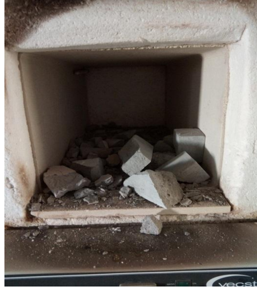
الشكل (3-32): تكسر العينات بفعل الحرارة العالية
