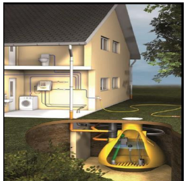
Figure 109 : Récupération des eaux pluviales
