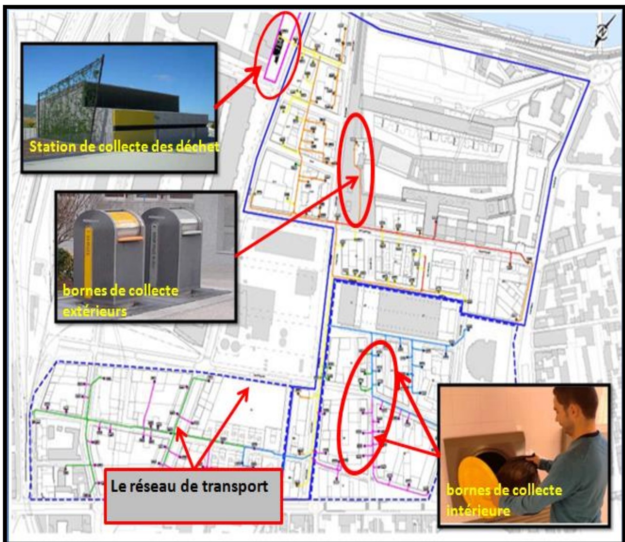
Figure12 : schéma système de la collecte pneumatique -Ville de Saint-Ouen France Source : www . Saint-Ouen France. FR / Arrangé par auteur
