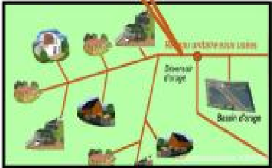
Schema10 : réseau unitaire des eaux usées, source : Traitement des eaux usées Daniel Thévenot & Gilles Varrault Cereve Université Paris XII-Val de Marne, ENPC, ENGREF (UMR-MA 102), http://www.enpc.fr/cereve/HomePages/thevenot/enseignement.html
