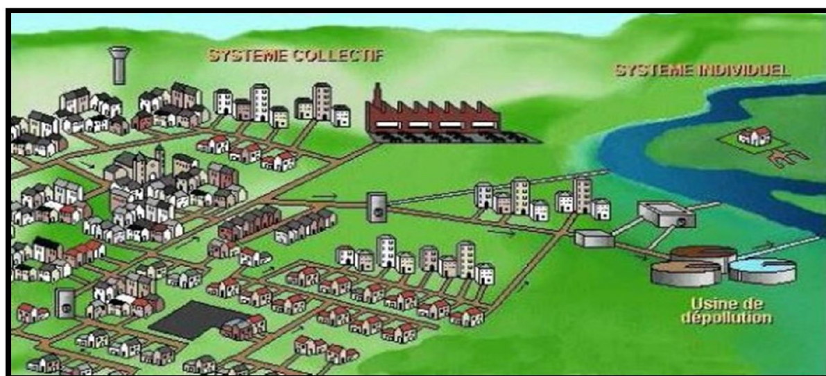
Schéma3 : système d'assainissement, source : document Traitement des eaux usées Daniel Thévenot & Gilles Varrault Cereve Université Paris XII-Val de Marne, ENPC, ENGREF (UMR-MA 102), http://www.enpc.fr/cereve/HomePages/thevenot/enseignement.html
