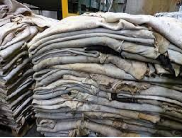
الصورة 51: الخطوة 1 للدباغة فرز الجلد
