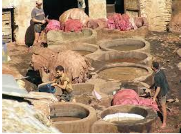
الصورة 52: الخطوة 2 للدباغة مرحلة النهر
