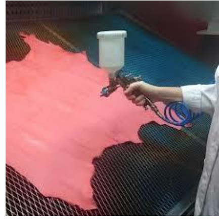
الصورة 54: الخطوة 4 للدباغة صبغ الجلد
