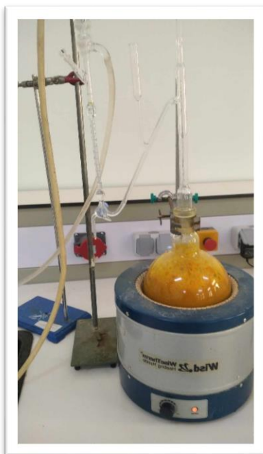
Figure 05 : Montage d'extraction par hydrodistillation d'huile essentielle de curcuma
