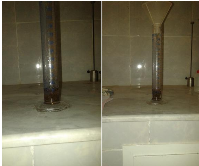
Figure11 : Eprouvettes pour la mesure de la masse volumique.
