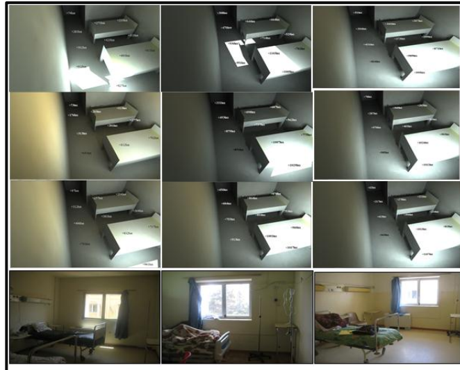
Figure96: Comparaison par images des niveaux d'éclairage intérieur moyen pour la chambre d'hospitalisation orthopédie03 dans les différentes périodes de l'année Source: Auteur
