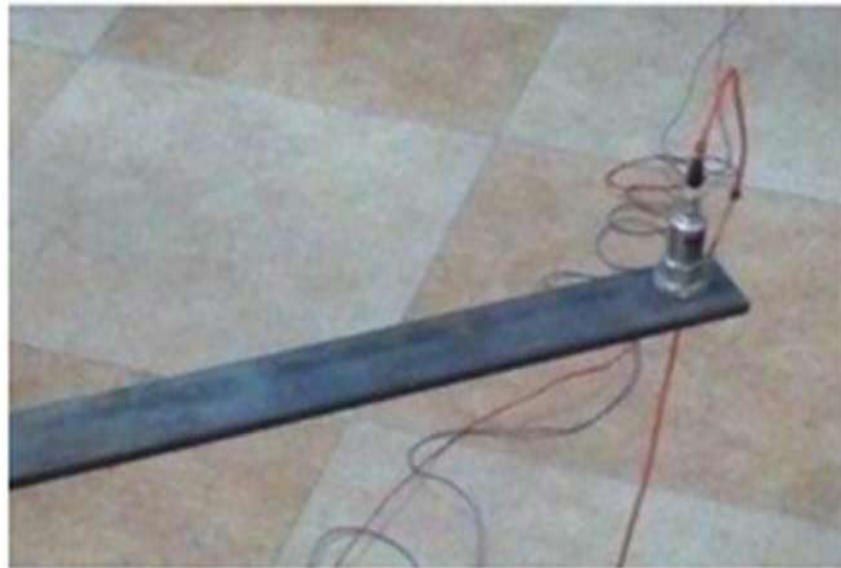
Figure 03 : Accéléromètre placée sur la poutre en porte à faux pour les tests dynamiques [12]
