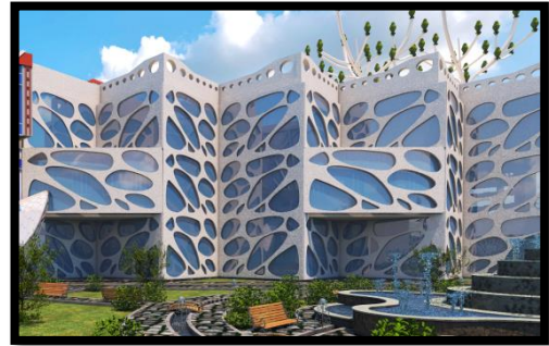
FIG03 : facade double peaux, source : l'auteur
