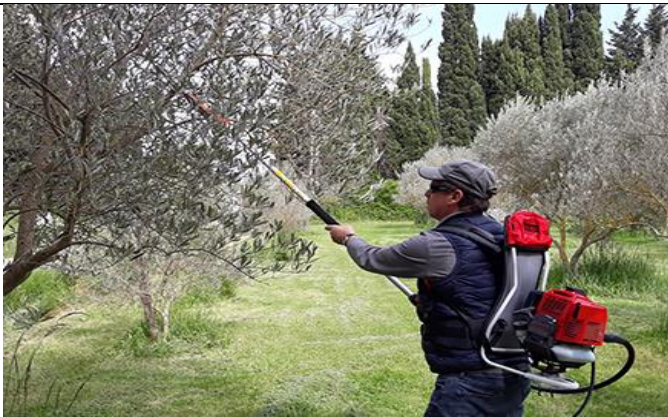
Figure 5: Récolte par un peigne vibreur
