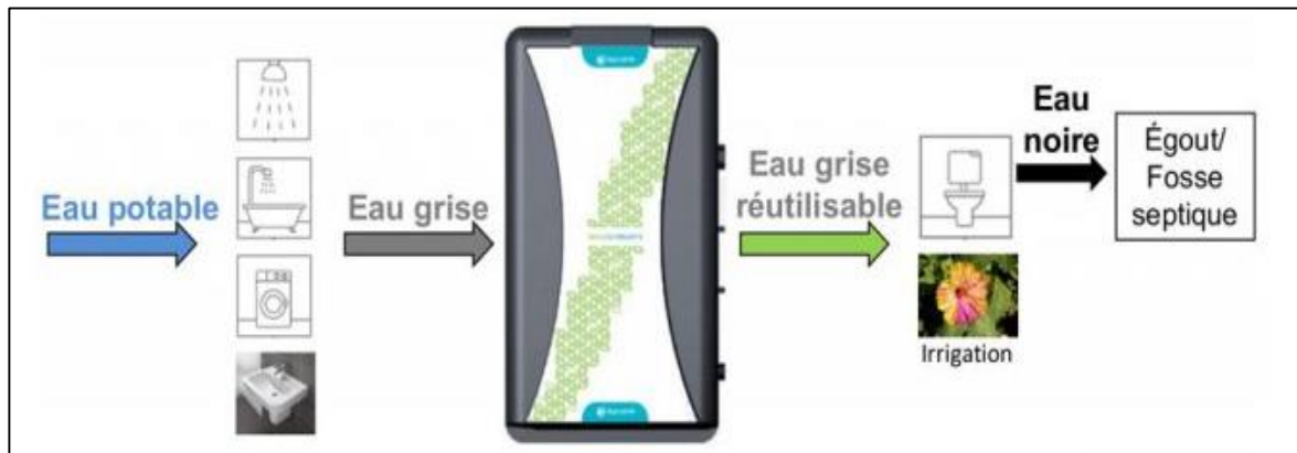
Figure 55 Récupérer les eaux grises pour chasser l'eau des toilettes ou arroser le jardin
