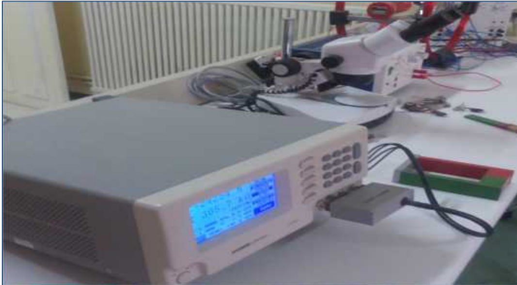
Figure II.10 : matériel utilisé pour les mesures de magnétorésistance sur de multicouches Cu/Co
