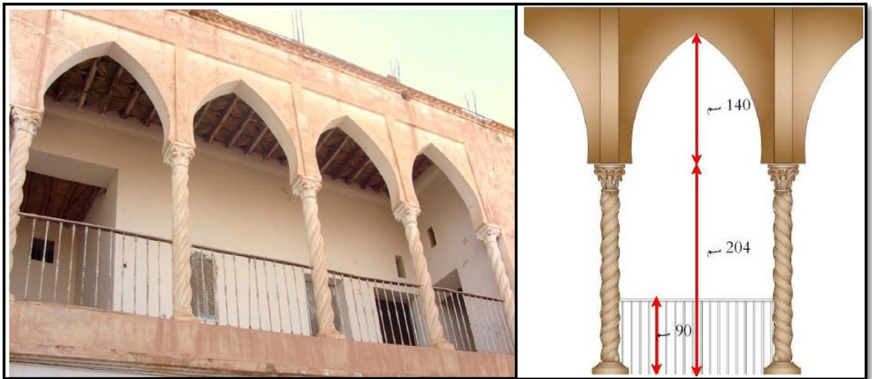
Figure 58 : Coupe schématique des arcs. (Source par l'auteur)
