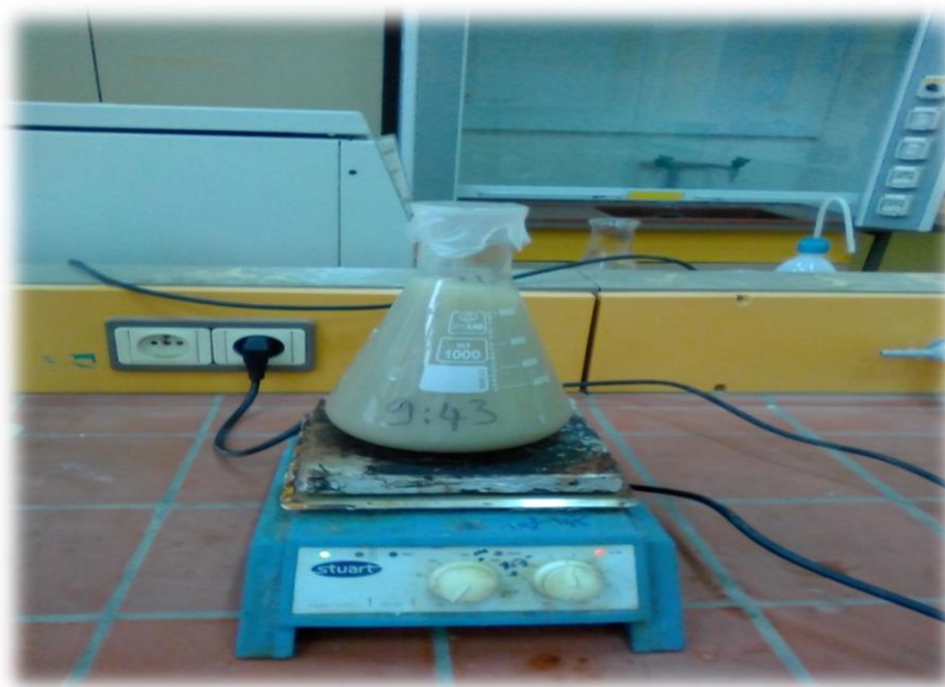
Figure III.18 : Le mode de purification de la montmorillonite naturelle.
