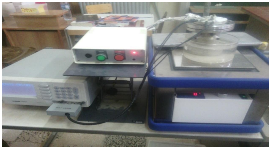
Figure III.17 : Régulateur thermique relié avec l'impédance mètre GWINSTEK, LCR-821.
