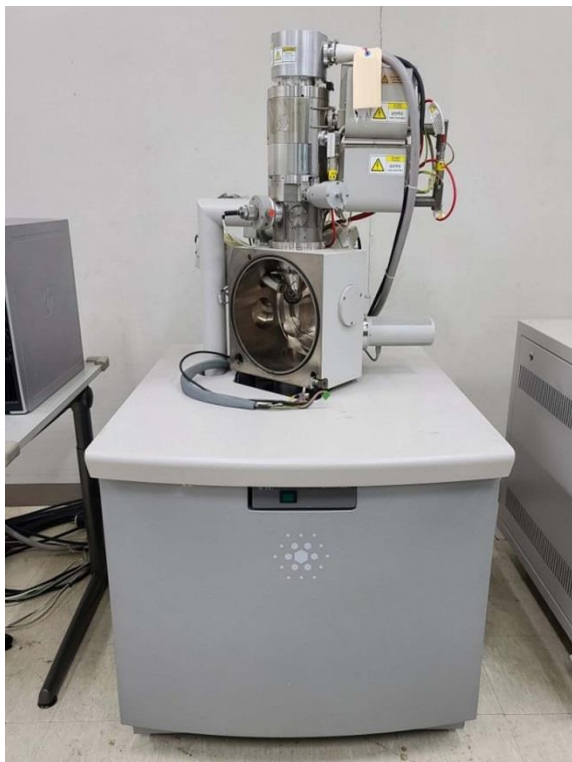
Figure III.7 : photographie d'un microscope électronique à balayage SEM, Quanta-650.
