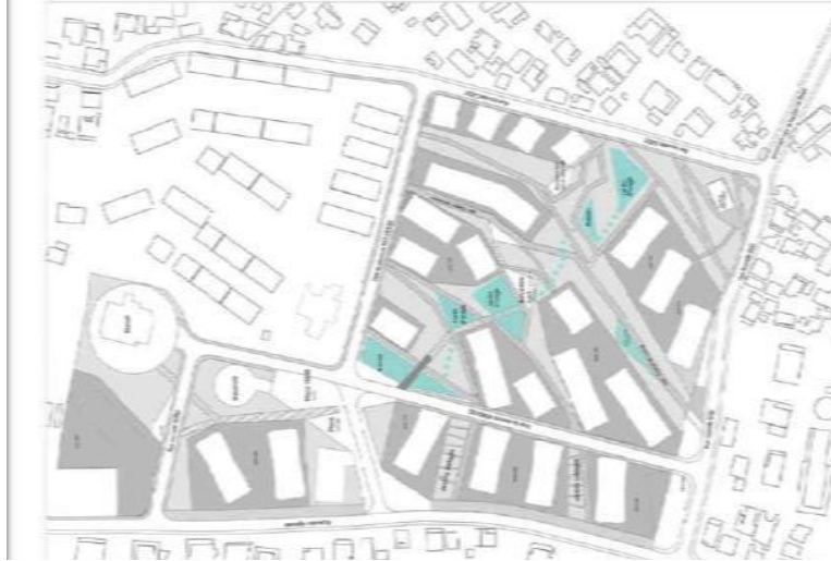
شكل 2. 12 أحواض تجميع مياه الأمطار المصدر:
