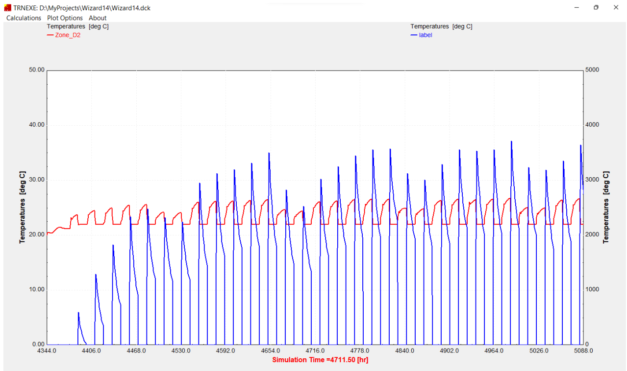
Figure IV. 12: le changement de la température en cas de climatisation avec isolation thermique avec la consommation de l'énergie.
