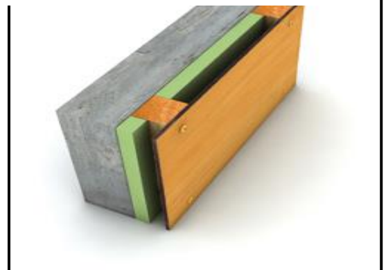
Figure 78 : façade ventilée Source : équipe A.ZERARGA HOCINE
