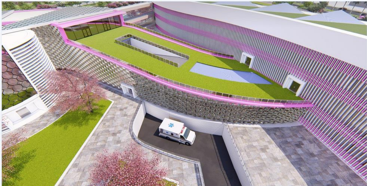
Figure 218:les brises solaires dans la façade postérieure
