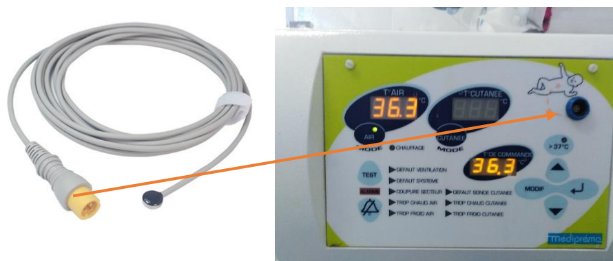
Figure II.4: L'emplacement de la sonde cutanée sur l'appareil.
