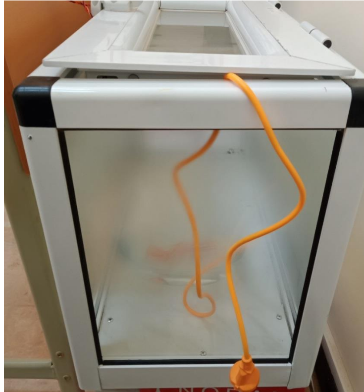
Figure III.11 : Montage de test d'humidité et température à l'aide de capteur DHT11. La figure ci-dessus illustre l'humidité au niveau des parois de la couveuse.
