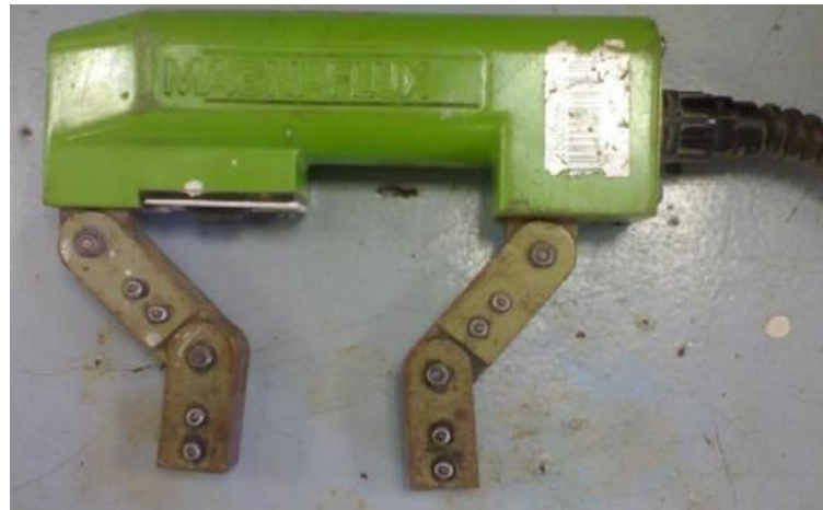
Figure. I.4. Appareil de contrôle par magnétoscopie.
