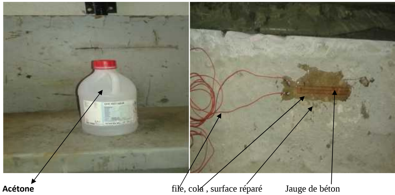
Figure 5.10 : la surface de béton réparé et la solution de l'acétone et placement par la cola
