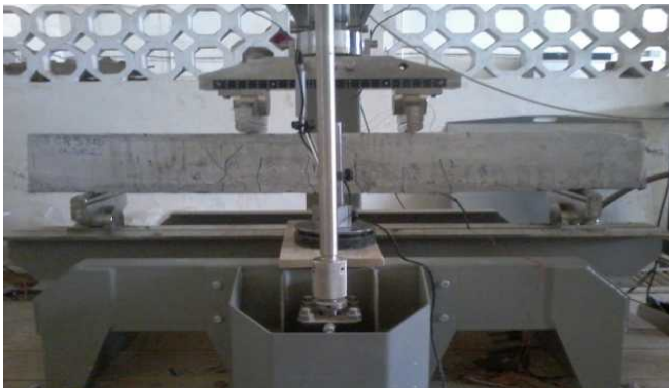
Figure 5. 6 : Essai de flexion par quatre point (B 350 CRS AA)
