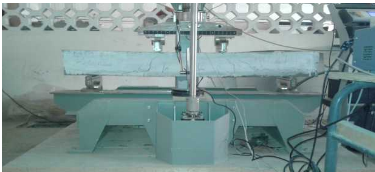
Figure 5. 5: Essai de flexion par quatre point (D CRS 350 SA)
