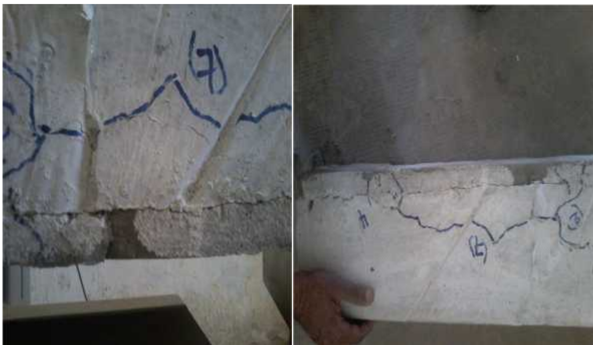
Photon°22 L'adhérence dans la poutre réparée
