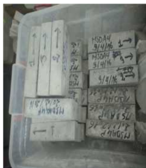
Photo n°16 : éprouvette 4x4x16(conservation à l'air libre)
