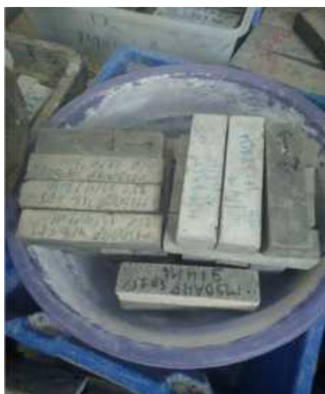
Photo n°16 : éprouvette 4x4x16(conservation à l'air libre)
