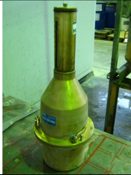
(b) Roll-a-meter d'un volume de 2,1 litres (R)
