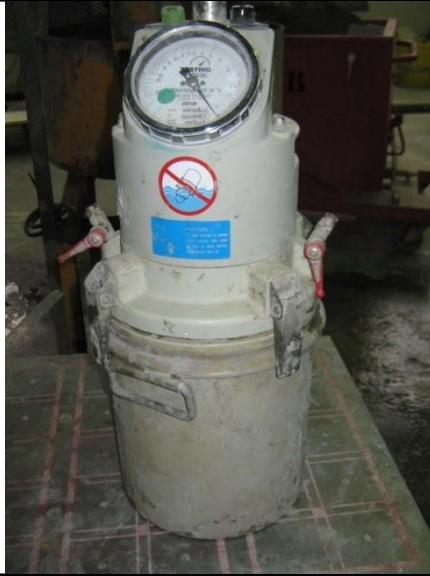
a) Aéromètre à béton d'un volume de 8 litres (A)
