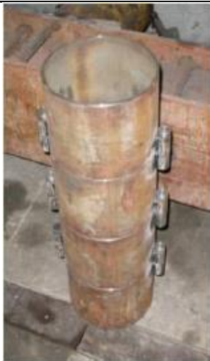
(a) Colonne de 20 cm de diamètre et 66 cm de long
