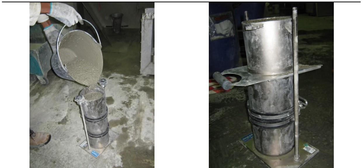
Colonne cylindrique de 150x450 mm
