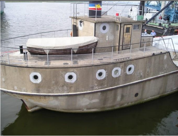
navire en béton léger datant de 1943
