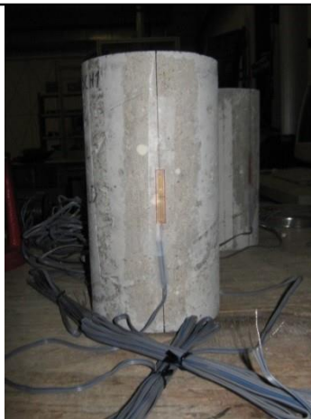
Eprouvette équipée de jauges de déformation
