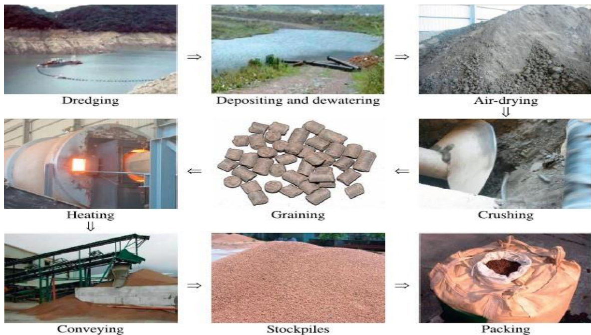
Figure I.10 : Processus de fabrication de granulats léger à partir de boue issue de réservoir de décantation
