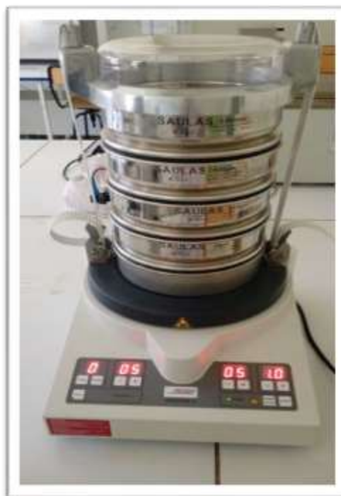
Figure 6 : l'appareil de granulométrie utilisé pour le tamisage.
