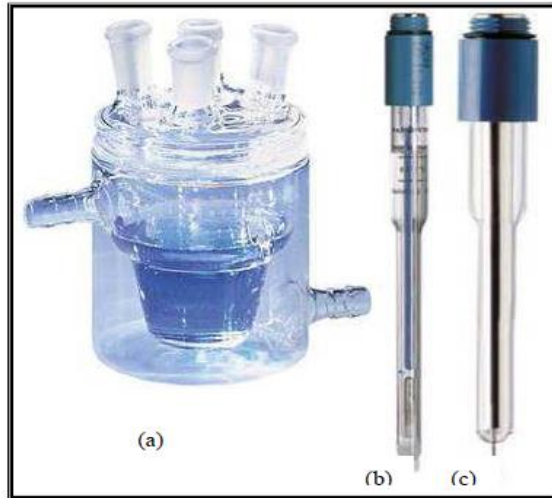
Figure 5. (a) cellule de mesure. (b) électrode de référence. (c) contre électrode en platine
