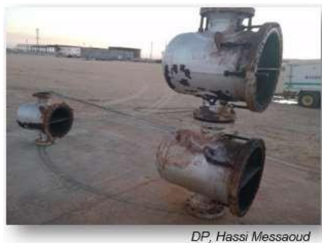
Figure I.3 : boîte de distribution.
