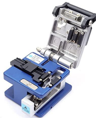
Figure III - 17 : Cliveuse fibre optique
