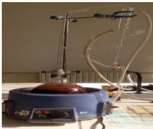
Figure 06: Dispositif de l'hydrodistillation à l'échelle du laboratoire – Appareil Clevenger(Original.,2020)
