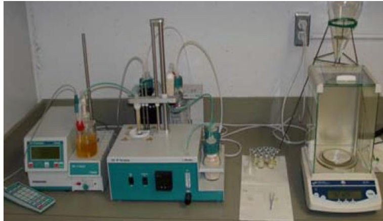
Fig. II.3: Titreur Coulométrique Karl Fisher pour la mesure de la teneur en eau de liquide isolant. [15]
