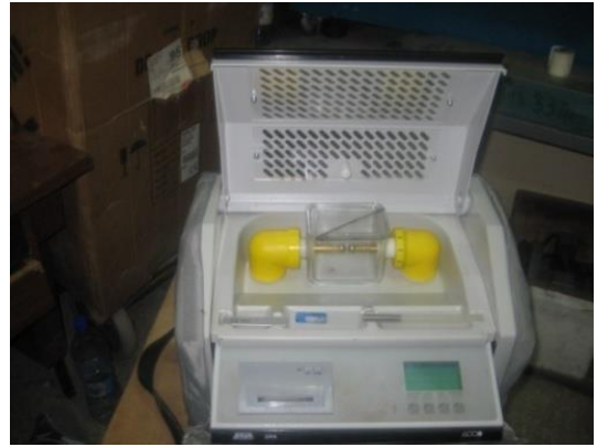
Fig. II.6 : Schéma de la cellule de mesure de la tension de claquage [3, 24]
