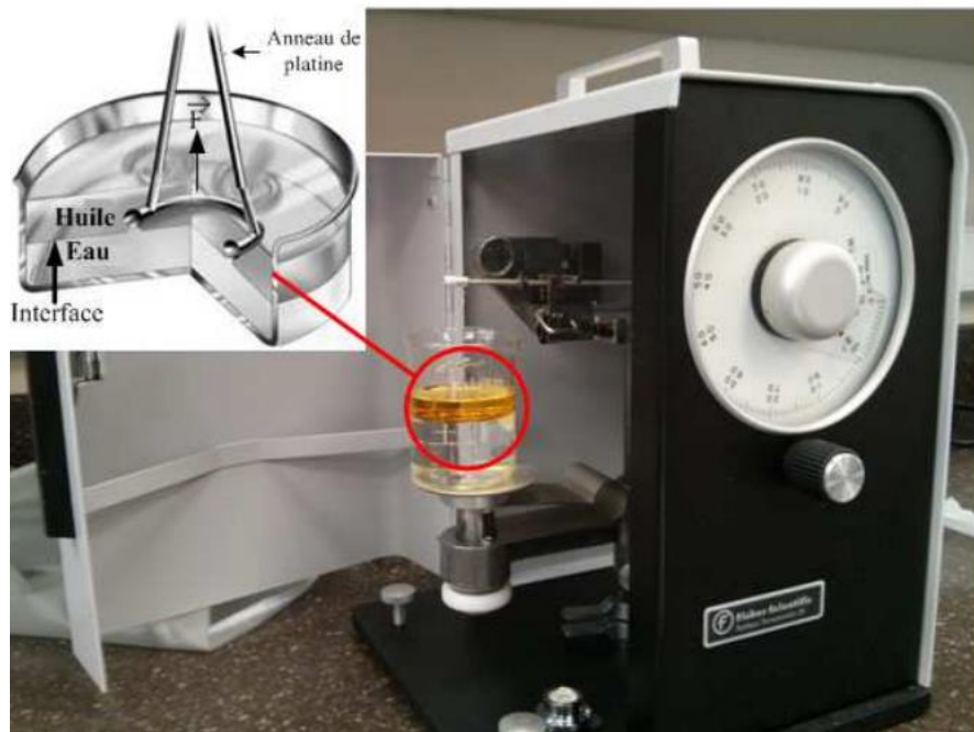
Fig. II.4 : Tensiomètre pour la mesure de la tension interfaciale [4].
