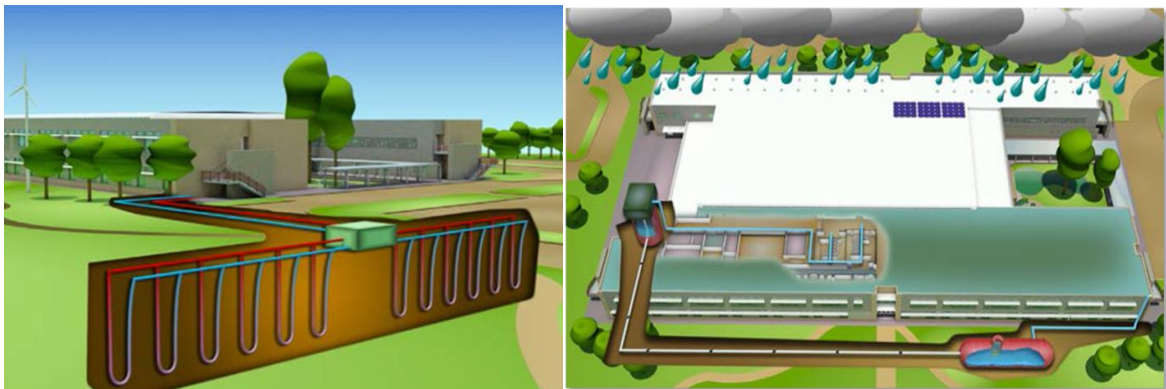
Figure I-47: la géothermie et collecte des eaux pluviales.
