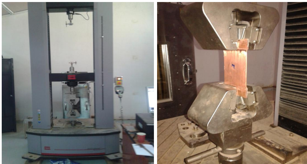
Figure III-2. Essais de traction avec une machine MTS (laboratoire de génie mécanique université de LAGHOUAT).
