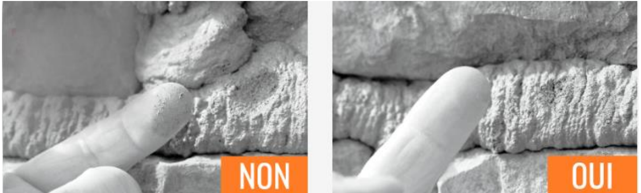
Fig III.7 : essais pour évaluer le moment exact pour travailler le joint [Geopietra, 2020].
