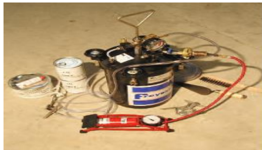
Fig III.13 : Préparation du matériel et des produits nécessaires à une injection [ Guide strres, 2013 ].
