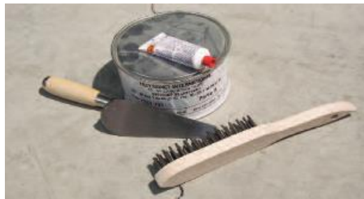
Fig III.12 : Matériel nécessaire au nettoyage des fissures et à leur cachetage [ Guide strres, 2013 ].
