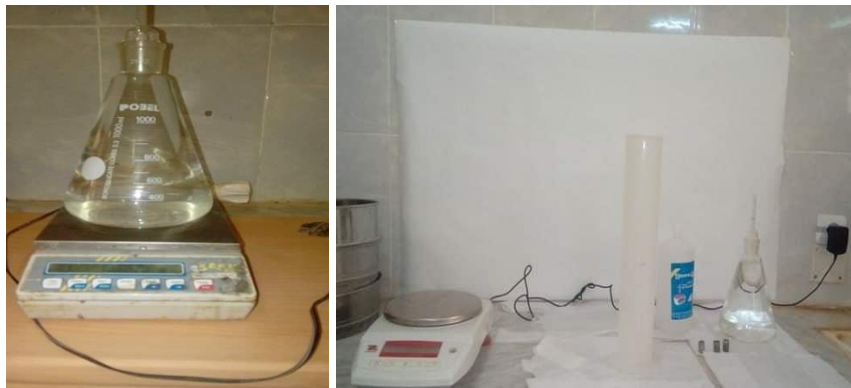
Figure III.7 : Essai de mesure la masse volumique des fibres d'alfa.
