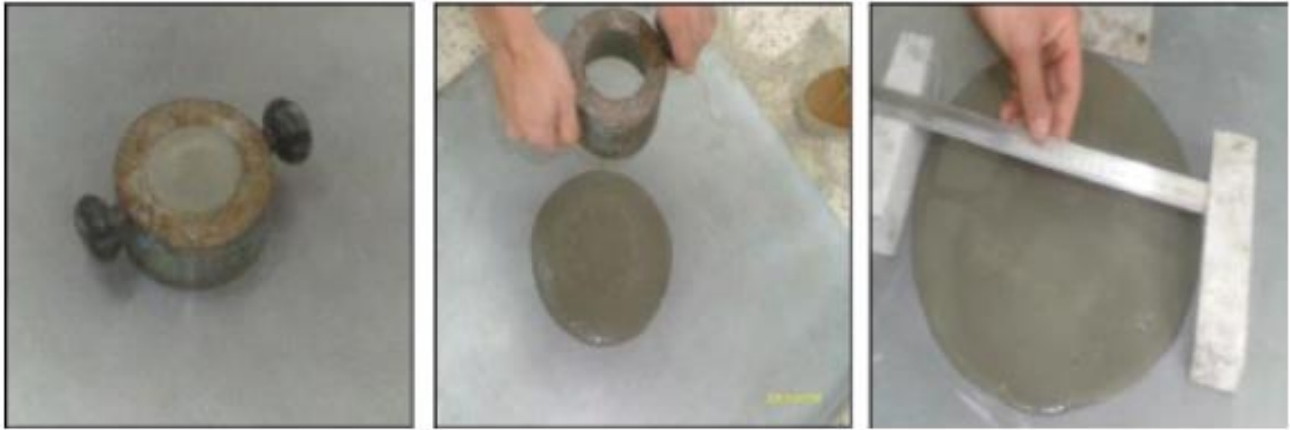
Figure I.10 : Essai d'étalement pour mortier autoplaçant.
