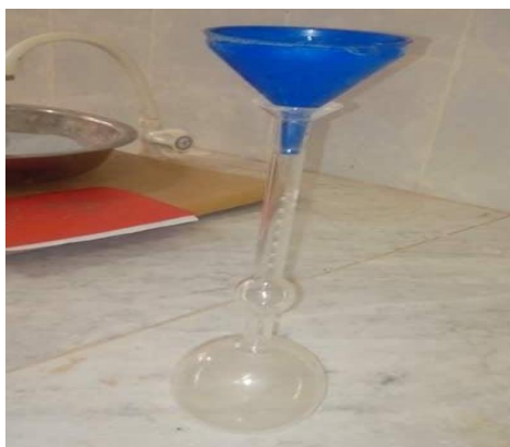
Figure III.11 : Essai de mesure la masse volumique de fumées de silice.
