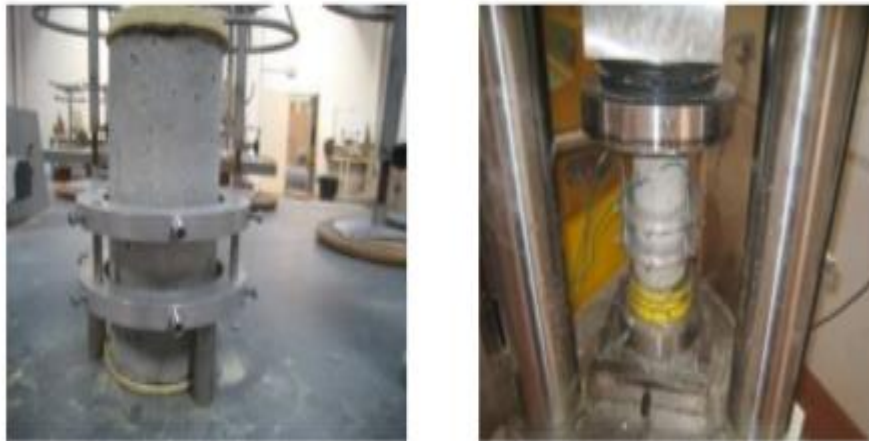
Figure II.41: Principe de l'essai de module d'élasticité.
