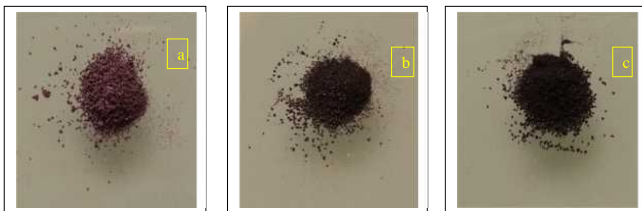
Fig. III-8 : traitement thermique du composé \text{Li-Co-IO}_3 à différentes températures
