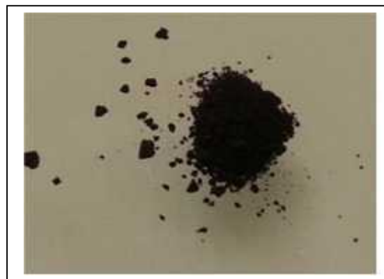
Fig. III-36: Le Co-IO 3 - Cl à T=450°C
