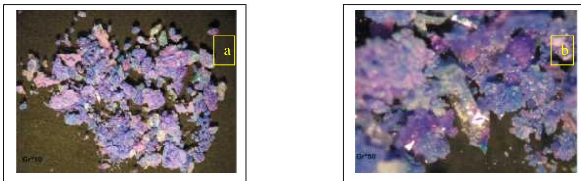
Fig. II-4 : vue pris par stéréo microscopie de synthèse CoCl_2 avec KIO_3 à défèrent agrandissement a-Agrandissement*10 b-Agrandissement*50
