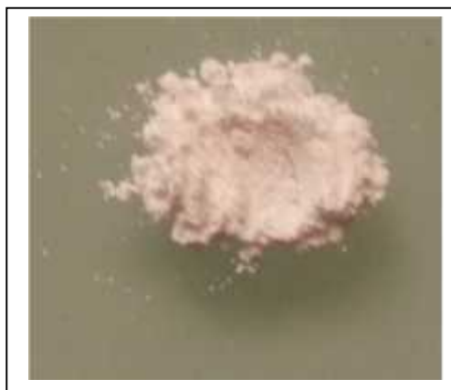
Fig. III-21 : poudre de la synthèse MgIO 3 avec KIO 3 avant le traitement
