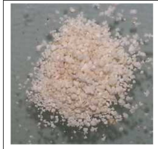
Fig. III-47 : Le Mg-IO 3 - Cl à T=250°C
