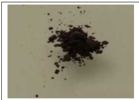
Fig. III-35 : Le Co-IO 3 - Cl à T=350°C
