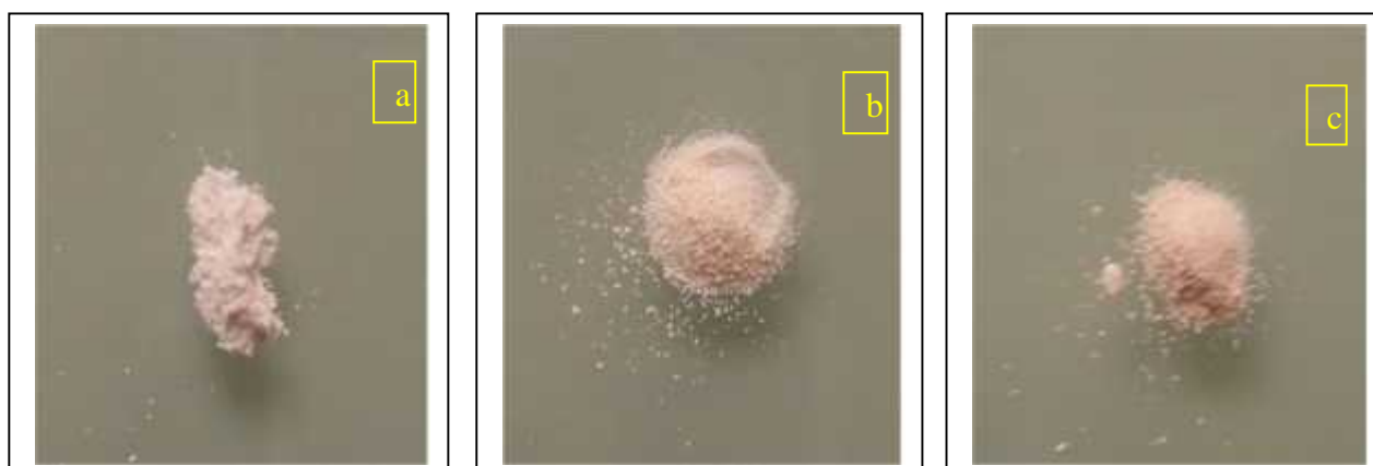
Fig. III-4 : traitement thermique du composé Li-Zn-IO_3 à différent température
