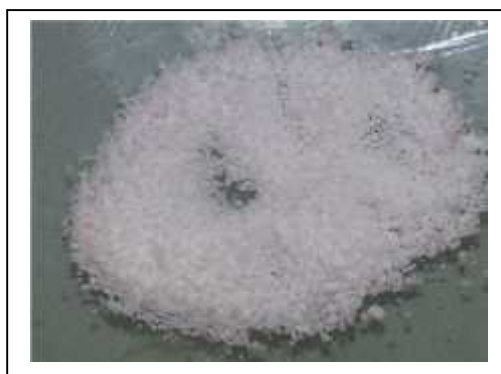
Fig. III-45 : Le Mg-IO 3 - Cl avant le traitement
