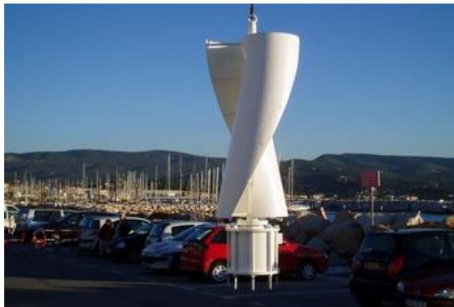
Figure II.6 Une éolienne à axe vertical de type Savonius sur un parking à la Ciotat.
