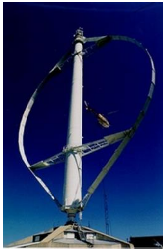
Figure II.7 éoliennes de type Darrieus
