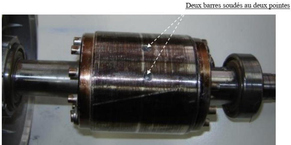
Figure I.4: Défaut deux barres cassées
