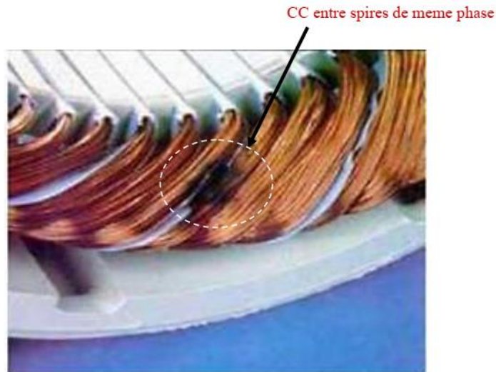
Figure.I.8: Court-circuit dans une phase [8].
