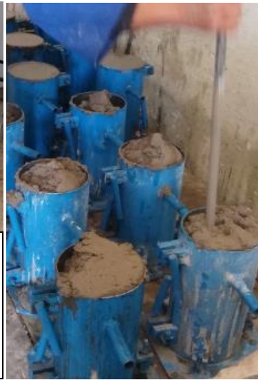
Fig. II.14 : Confection de 09 éprouvettes cylindriques (pour écrasement) et 12 éprouvettes prismatiques dont 09 pour écrasement et 03 pour l'essai de retrait.
