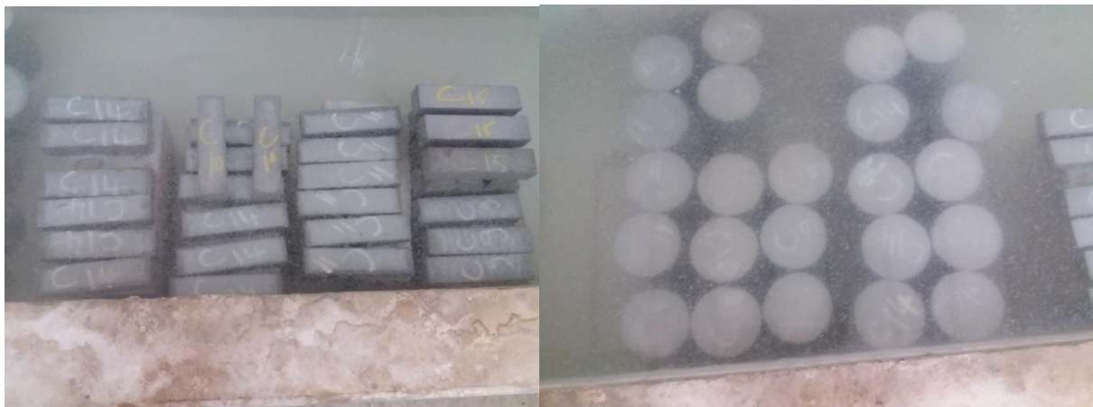
Fig. II.21 : Conservation des éprouvettes dans des bacs galvanisés à une température maintenue constante à 21 \pm 1^\circ\text{C} .
