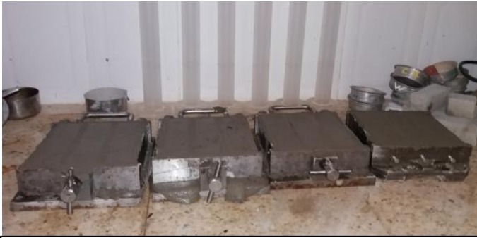
Fig. II.14 : Confection de 09 éprouvettes cylindriques (pour écrasement) et 12 éprouvettes prismatiques dont 09 pour écrasement et 03 pour l'essai de retrait.
