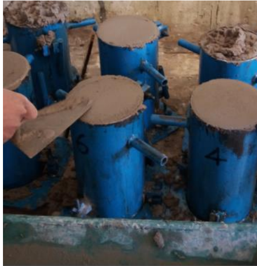
Fig.II.19 : Arasement des éprouvettes
