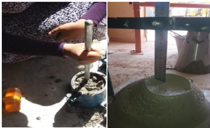
Fig.II.17 : Serrage par piquage (Affaissement > 9cm)
