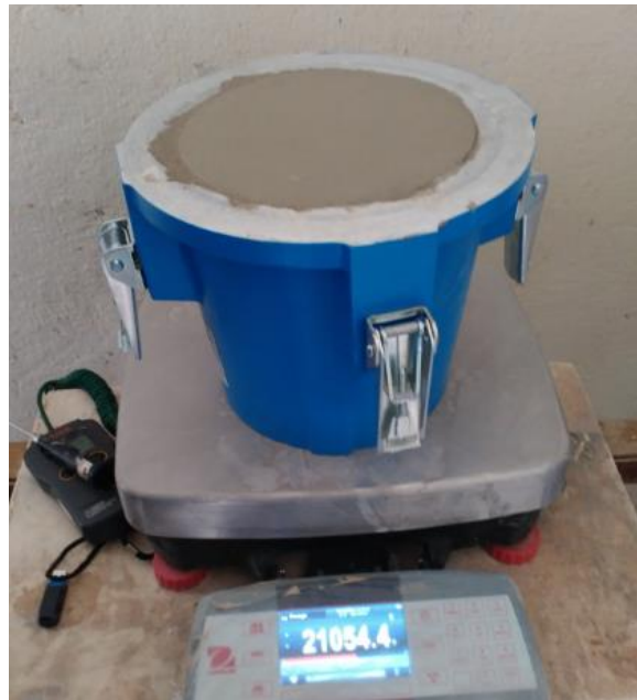
Fig.II.13 : Mesure de la masse volumique du béton frais
