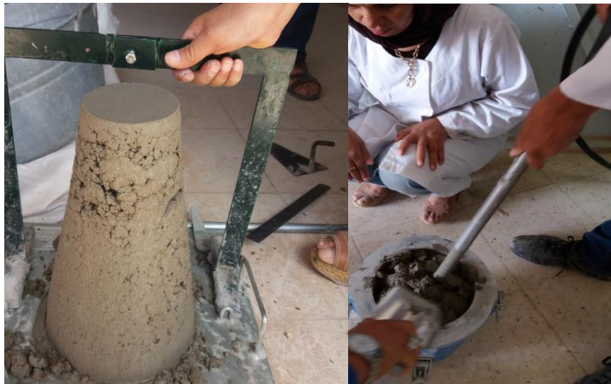
Fig.II.18 : Vibration par aiguille vibrante (affaissement <9cm)
