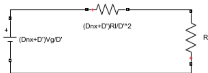
Figure III-35 Circuit simplifié du modèle de transformateur DC
