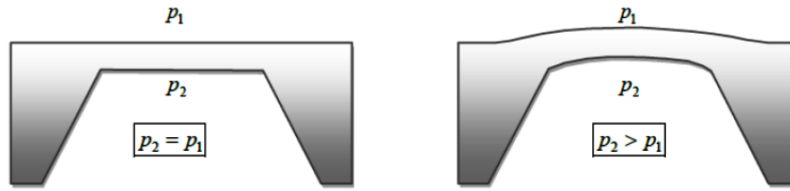
Figure (I.17) : Schéma de la déformation de la membrane d'un capteur de pression
