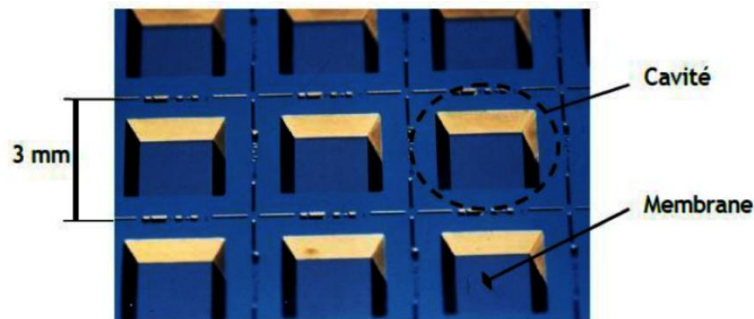
Figure (I.16): Production collective de MEMS qui seront séparés en toute fin du procédé Visualisation de la cavité réalisée pour obtenir la membrane en silicium [18].
